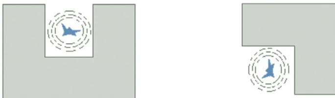
Slika 3: Oblike objektov, ki povečajo učinek udarnega vala eksplozije (narisano po Hinman, 2009)
