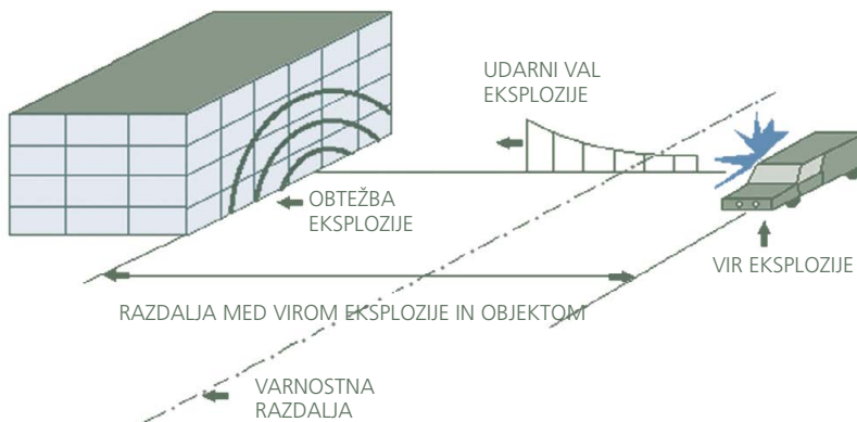
Slika 6: Varnostna razdalja med virom eksplozije in objektom, na katerega eksplozija deluje (narisano po Hinman, 2009)
