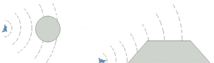
Slika 4: Oblike objektov, ki zmanjšajo učinek udarnega vala eksplozije (narisano po Hinman, 2009)
