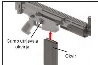
Slika 4.20: Vstavljanje okvirja v orožje
