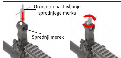
Slika 4.12: Nastavitev sprednjega merka po višini
