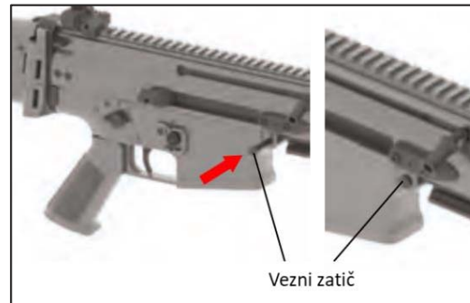
Slika 5.28: Utrjevanje veznega zatiča
