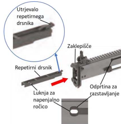
Slika 5.21: Vstavljanje repetirnega drsnika
