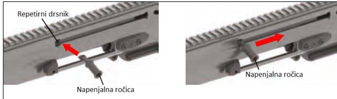
Slika 5.22: Nameščanje napenjalne ročice
