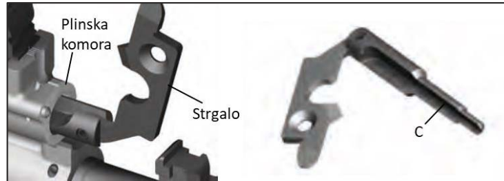
Slika 6.4: Čiščenje plinske komore
