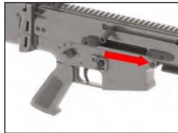
Slika 4.5: Sprostitev zaklepnega mehanizma v sprednji položaj
