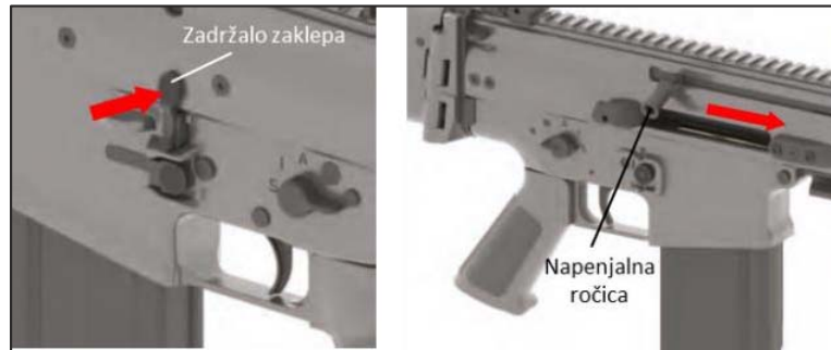
Slika 4.25: Menjava okvirja – sproščanje zaklepnega mehanizma
