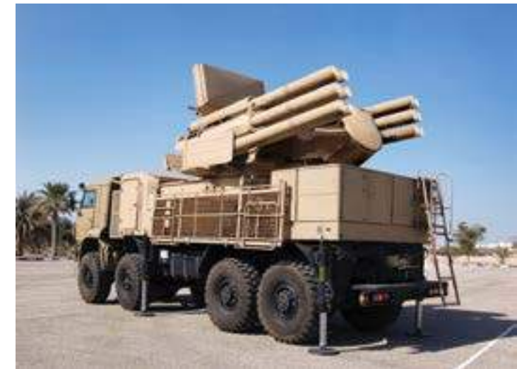
Slika 4: PANCIR S-1E oziroma 96K6 na vozilu MAN Cat SX 45 8 x 8 (Vir: KBP, 2016)
