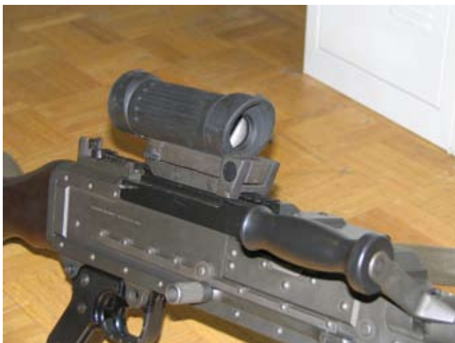
Puškomitraljez FN MAG, opremljen z optično namerilno napravo znamke ELCAN
