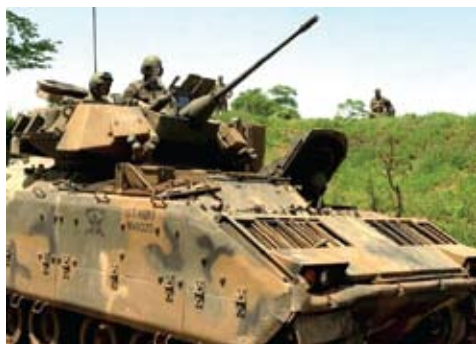
Oborožitev vozila BFVS (s topom M242 bushmaster kalibra 25 mm, sovprežni mitraljez M240C kalibra 7,62 mm)
