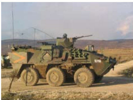
Vozilo Valuk, oboroženo z mitraljezom Browning M2HB QCB kalibra 12,7 mm
