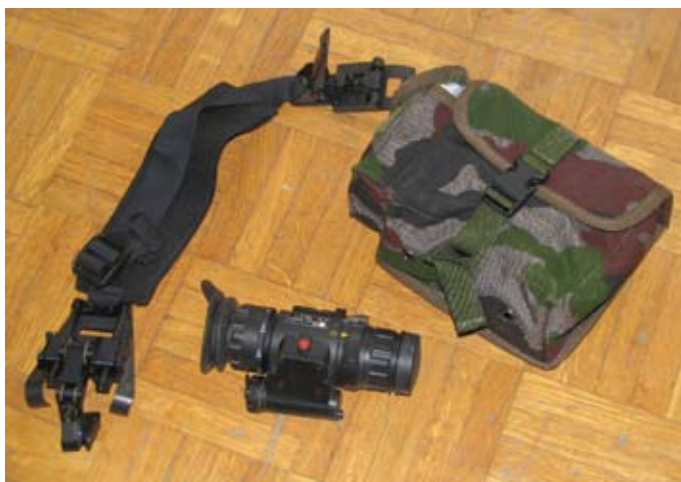
Belgijski monokularni nočnogled LORIS s sistemom za pritrditev na čelado in torbico za nošenje
