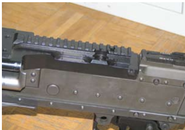
Puškornjaljez FN MAG 7, 62 x 51 mm, opremljen s Picatinnyjevo letvico
