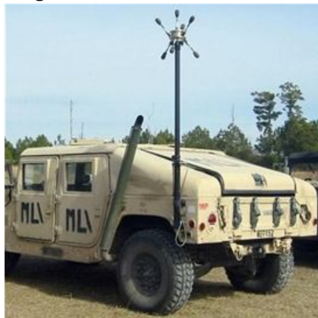
Slika 13: Boomerang sistem z nameščeno anteno iz mikrofoni
