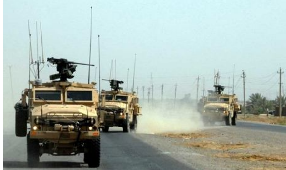
Slika 12: MRAP RG-33 Cougar 4x4 z oborožitveno postajo Protector M151
