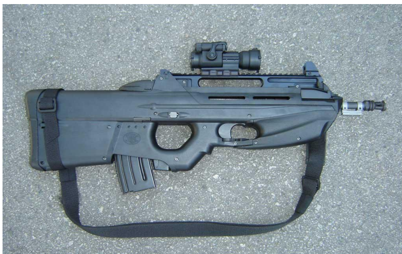
Slika 2: Avtomatska puška F 2000S 5,56 mm z optičnim merkom Aimpoint Comp M2 (OMA)
