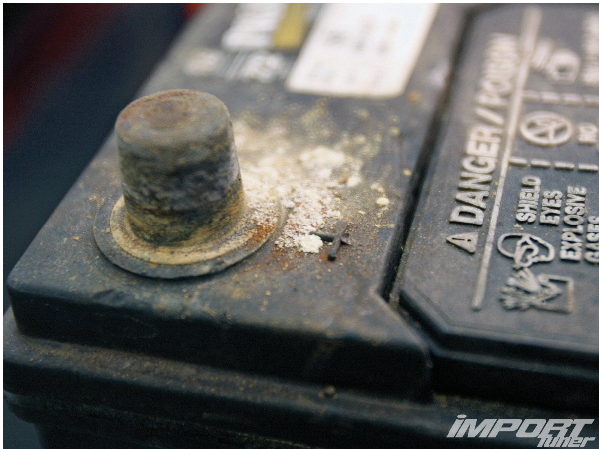
Slika 7: Korodirana priključna sponka akumulatorja
