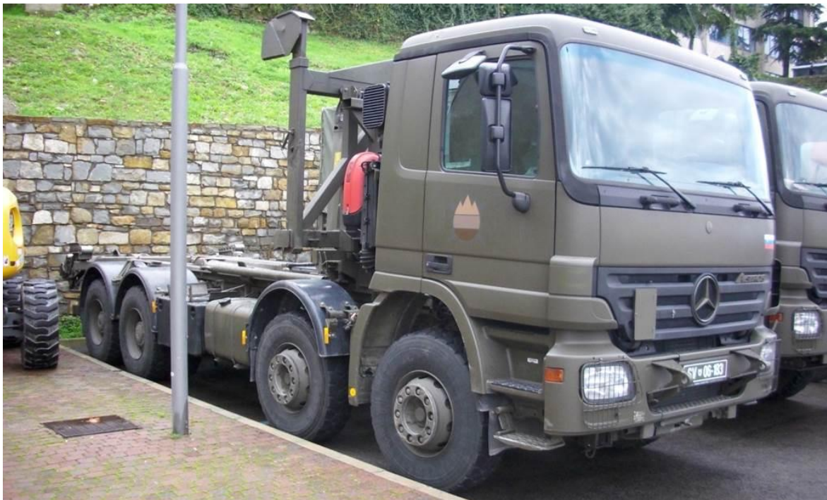
Slika 5: Mercedes Benz Actros z nadgradnjo za transport kontejnerjev
