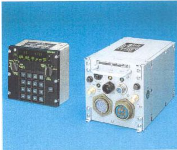
Slika 3: Zadnja generacija skupnega IFF transponderja MK. XII/model S stopnja 3
