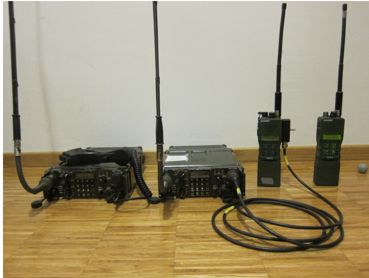
Slika 22: Šolski prikaz povezljivosti med Tadiran 04 in Harris 05
