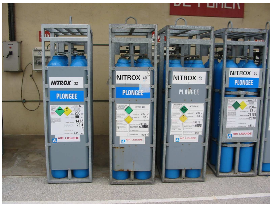
Slika 9: Baterije plinskih mešanic NITROX (ena baterija NITROX-32,5, dve bateriji NITROX-40 in ena baterija NITROX-60)
