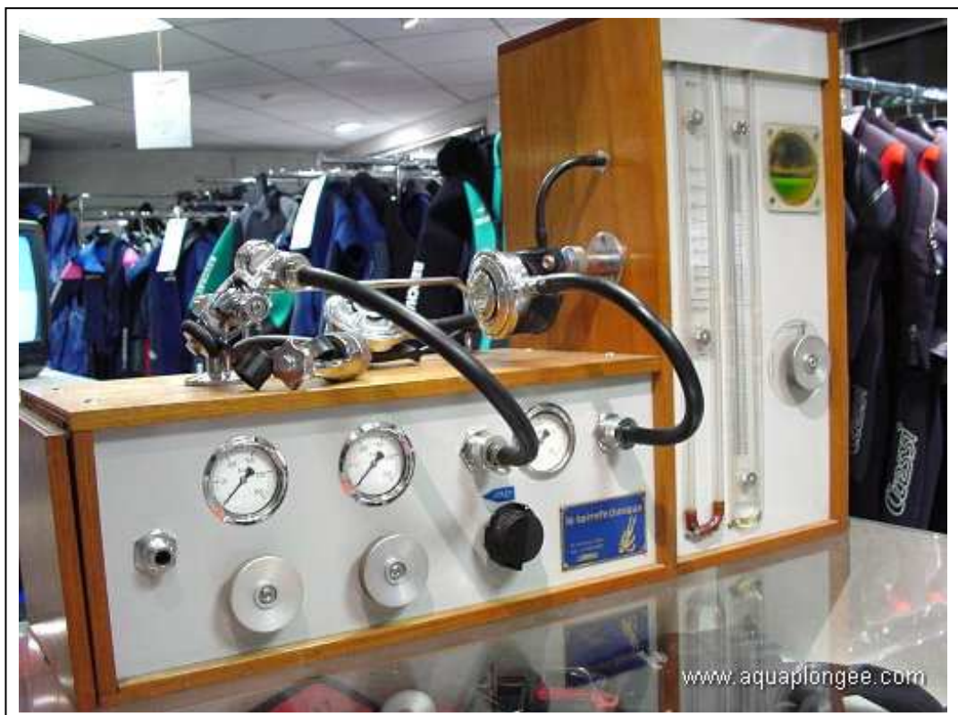
Slika 2: Testirna miza za testiranje hidrostatičnih regulatorjev AOKD
