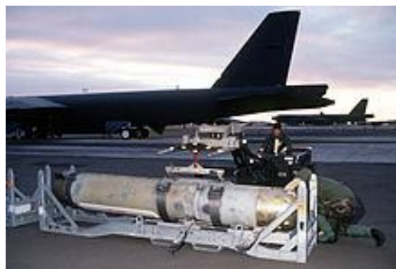
Slika 6: Na dnu ležeča torpedna mina CAPTOR
