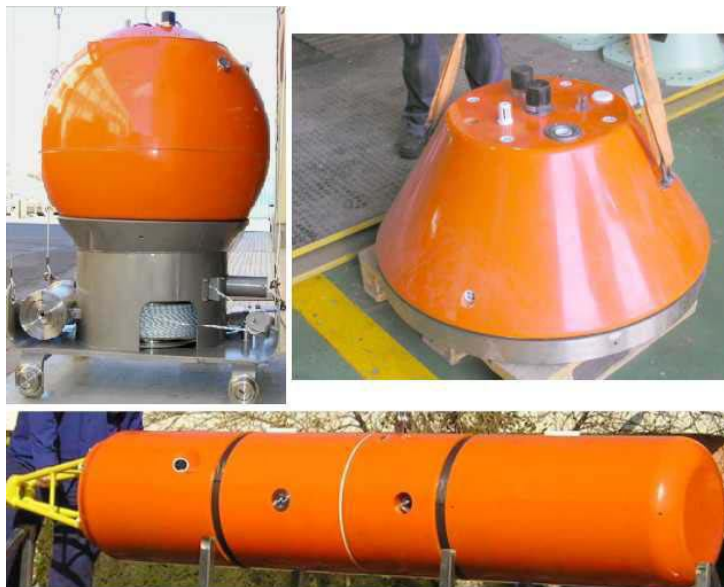
Slika 7: Več-vplivna mina MINEA (levo zgoraj:sidrna;desno zgoraj: na dnu ležeča mina nizkega profila; spodaj: cilindrična na dnu ležeča mina)
