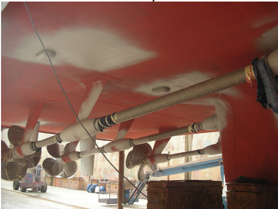
Slika 14: Osovine ladje TRIGLAV 11
