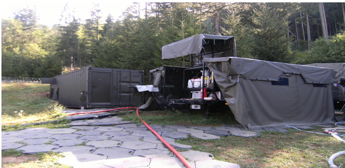
Slika 9: Prečiščevalna naprava za vodo WTC 1600 GT in WTC 5000 CG (kontejner)
