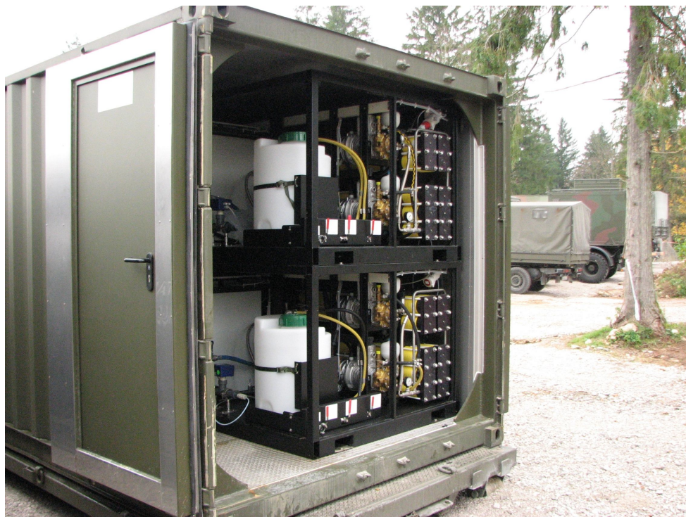
Slika 3: Prečiščevalna naprava za vodo WTC 5000 CG
