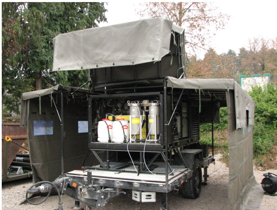
Slika 4: Prečiščevalna naprava za vodo WTC 1600 GT
