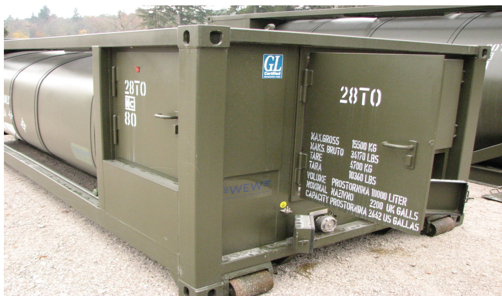
Slika 6: Kontejner rezervoar za vodo 10 m3 (WSDC 10)
