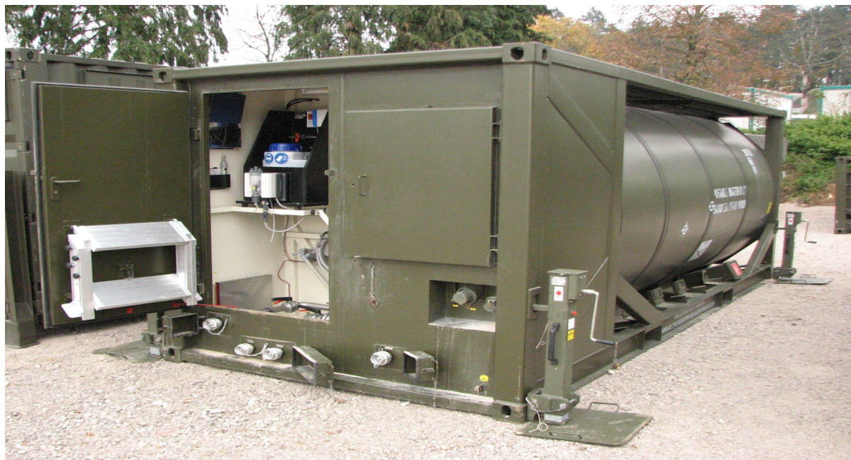
Slika 7: Kontejner rezervoar za vodo 16 m3 (WSDC 16)
