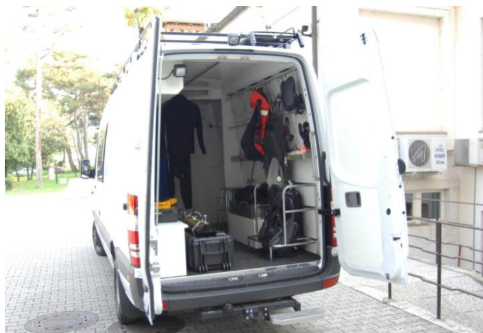
Slika 4: Specialno vozilo Mercedes Sprinter 4 x 4. V notranjosti tovornega prostora je vidna pripravljena potapljaška oprema in prostor za tuširanje, ki je ogrevan, kar omogoča delovanje potapljačev tudi pozimi na rekah in jezerih.
