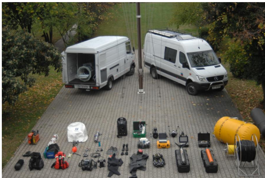
Slika 3: Specialno vozilo Mercedes. V notranjosti vozila je vidna pripravljena enomestna hiperbarična komora. Desno od omenjenega vozila specialno vozilo Mercedes Sprinter 4 x 4.
