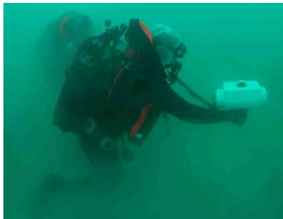
Slika 27: Potapljač s sonarjem DLS – 2A med preiskovanjem morskega dna
