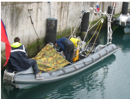
Slika 17: Čoln Č-61, pripravljen za izplutje in vleko SIDE-SCAN sonarja. Viden kolut z rumenim kablom, ki povezuje sonarja in računalnik .
