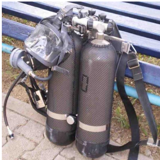
Slika 20: Komplet lahkega avtonomnega potapljaškega aparata odprtega kroga dihanja INTER SPIRO MK II
