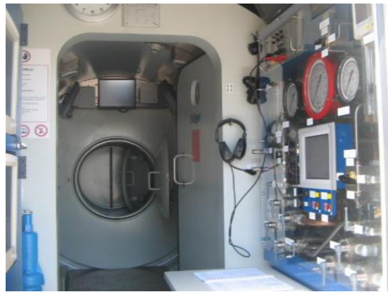
Slika 33: Notranjost glavnega zabojnika, kjer je vidna upravljalna miza in vhod v glavno komoro.
