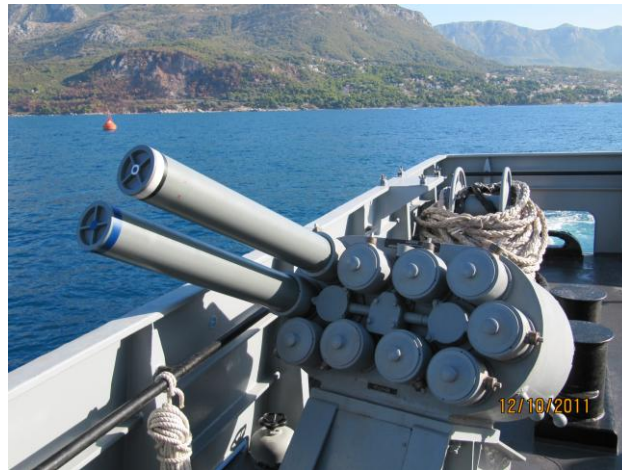
Slika12: Sistem za izstreljevanje vab na desnem boku ladje. Vidni sta obe polnitvi (beli trak označuje polnitev za protiraketni sistem, moder trak označuje polnitev za motenje radarske slike).
