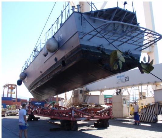
Slika 2: Postopek dvigovanja HPL Ankaran 21 za izvajanje rednega letnega remonta. Pripadniki odreda za podporo delovanja poskrbijo, da ima posadka ladje na voljo vse, kar potrebuje pri izvedbi remonta
