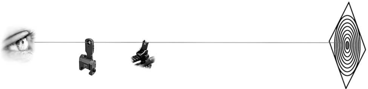
Slika 23: Uravnava mehanskih merkov
