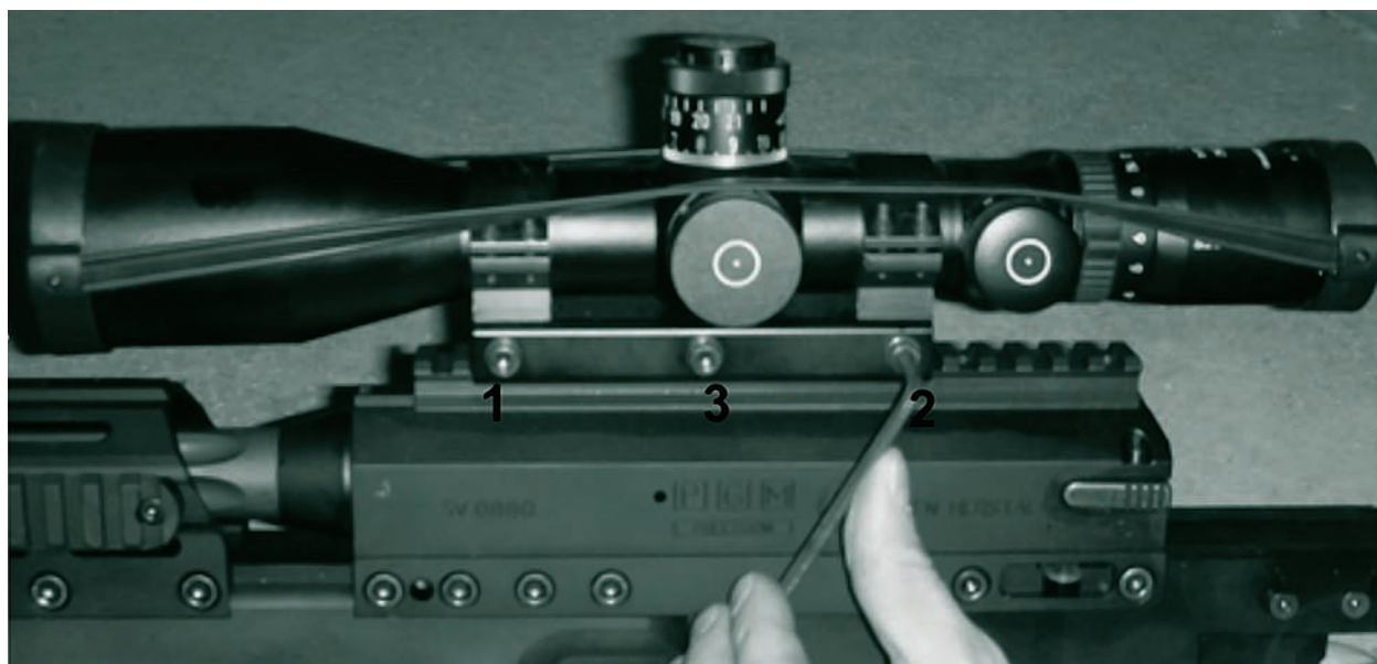
Slika 5: Odstranjevanje strelnega daljnogleda
