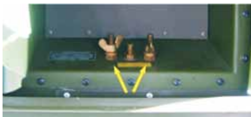
Slika 15: Krilni matici za pritrditev ozemljitve.
