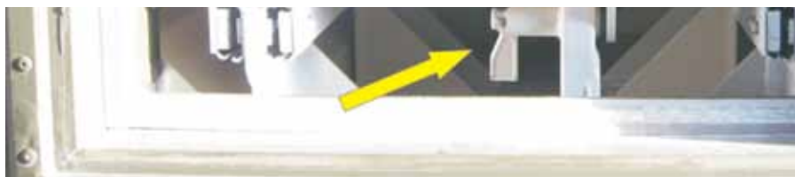
Slika 16: Zapah pod tračnico za elektroagregat.
