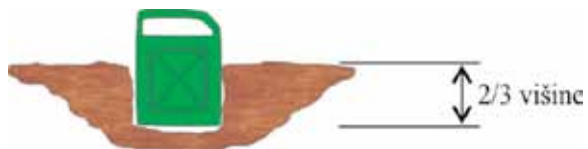
Slika 5: Shema pravilno vkopane kante za gorivo.
