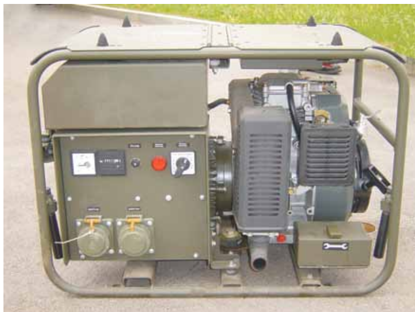
Slika 20: Elektroagregat KIRCH CE 2,5 KS – pogled s sprednje strani.
