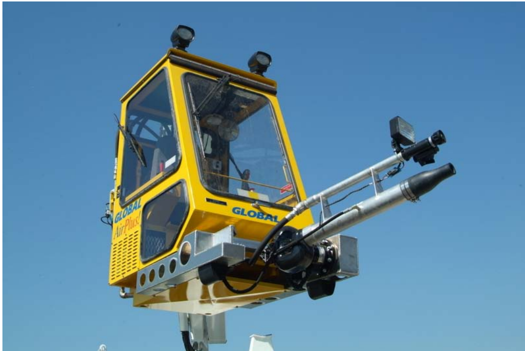
Slika 30: Delovna kabina za razledenitev letala
