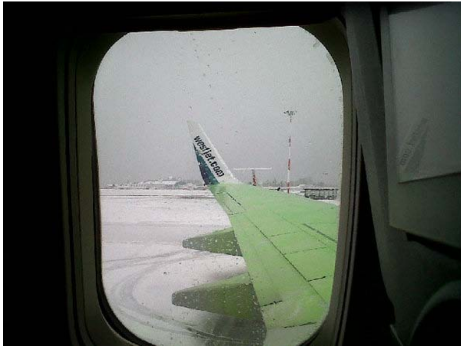
Slika 15: Krilo letala, zaščiteno z raztopino tipa IV
