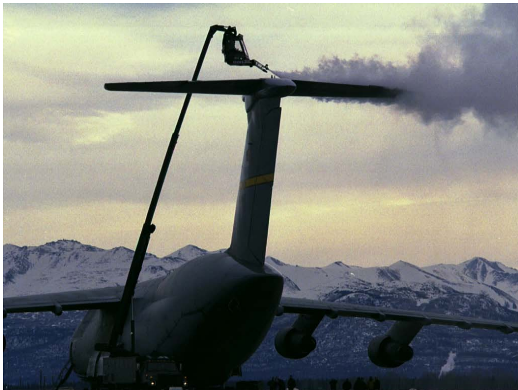
Slika 35: Razledenitev na najvišji točki letala
