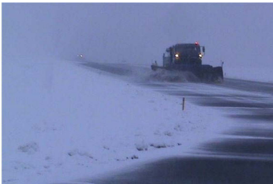
Slika 19: Čiščenje VPS s plugom
