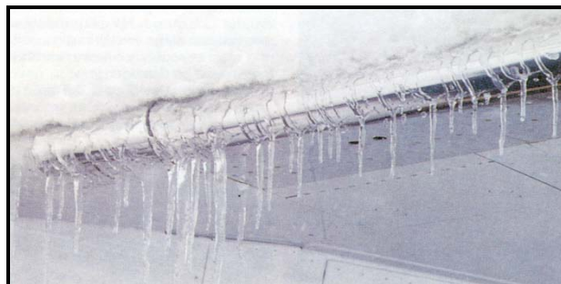
Slika 22: Primrznjen sneg in led na krilu letala
