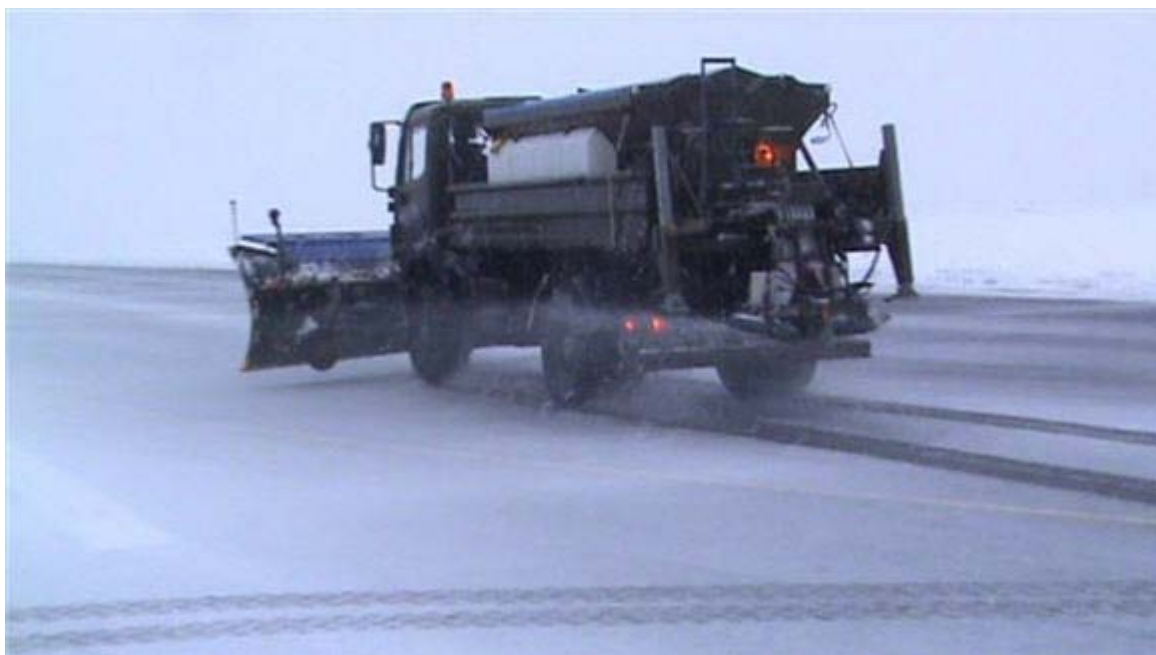
Slika 20: Posipanje VPS s kemičnimi sredstvi
