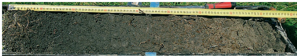
Slika 4: Talni profil – izvrtina mehkih organskih šotnih tal
