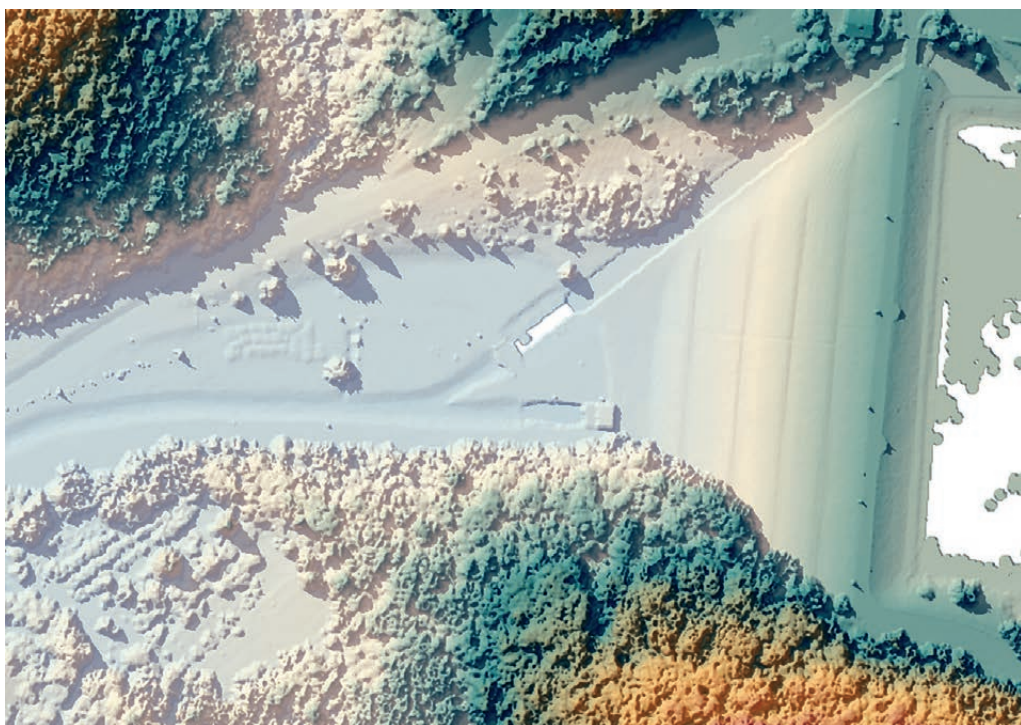
Slika 9: DMV zajezitve Vogrščka, narejen na podlagi laserskega skeniranja z gostoto 20 točk/m 2
