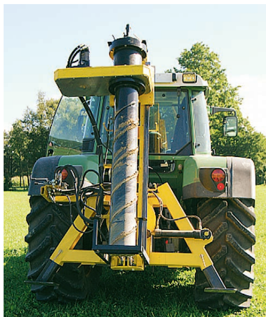
Slika 1: Vrtnalna naprava za odvzem neporušenih talnih vzorcev
