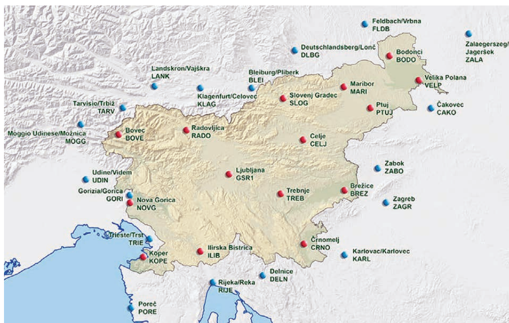
Slika 8: Državno omrežje permanentnih postaj GNSS, imenovano SIGNAL
