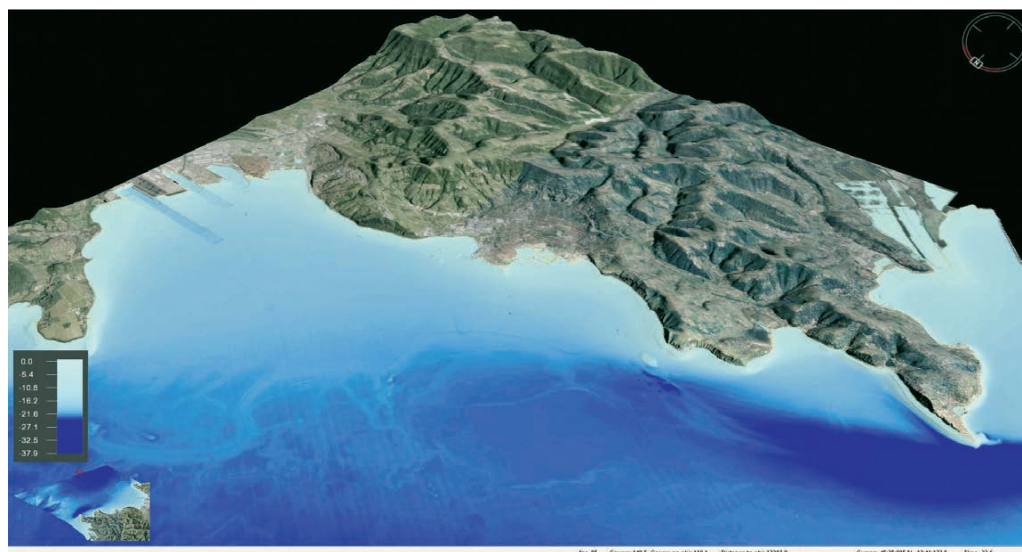
Slika 5: Zasloni izris uporabniškega vmesnika 3D-karte s približnim prikazom batimetrije dna in kopenskega dela. V spodnjem levem kotu se izrisujeta položaj in usmerjenost kamere pogleda, v zgornjem desnem kotu pa kompas trenutnega pogleda. Na spodnji informacijski liniji je podatek o trenutni smeri pogleda kamere, lokaciji puščice in globini oz. višini na tem mestu.
