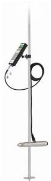
Slika 100: OTT ADC Acoustic digital current meter
