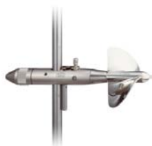
Slika 93: Hidrometrično krilo za merjenje hitrosti toka vode
