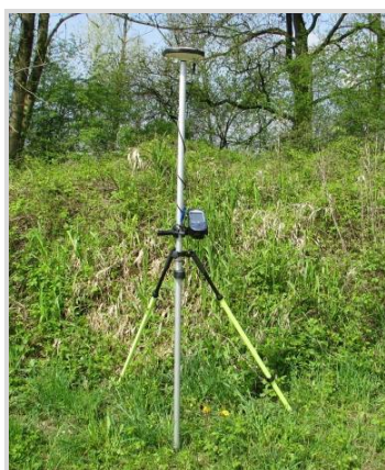
Slika 16: Primer GPS naprave z natančnejšo zunanjo anteno
