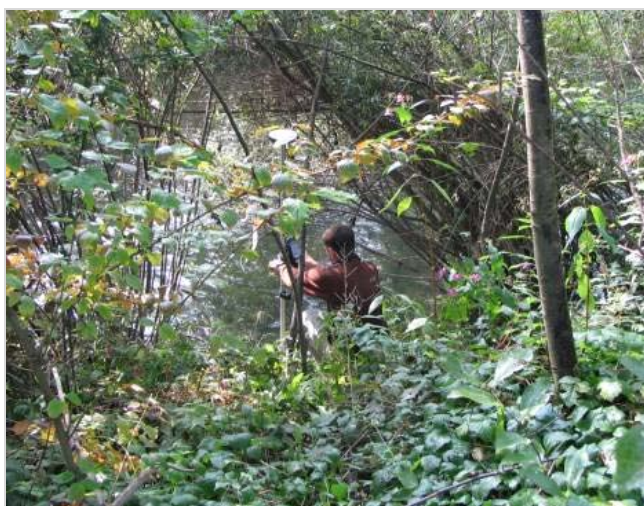
Slika 13: GPS meritev moti obrečno grmovje pri sprejemu satelitskih signalov
