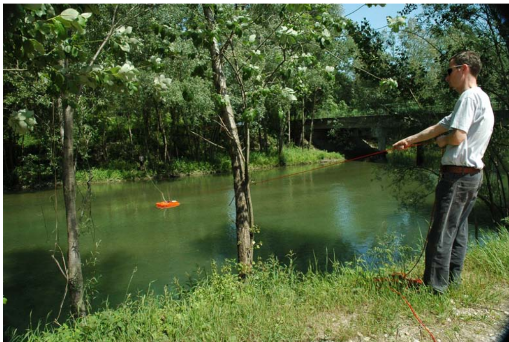
Slika 85: Merjenje hitrostnega polja z napravo ADCP na Kamniški Bistrici
