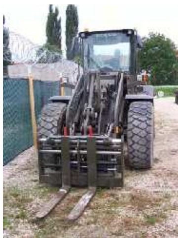
SLIKA 10: Traktorski viličar Volvo
