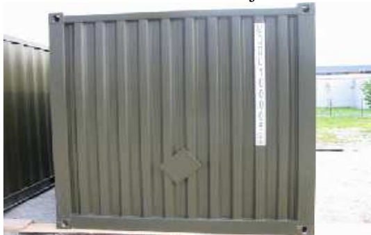
SLIKA 15: ISO kontejner 1C
