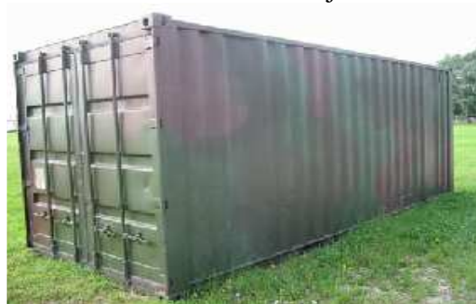
SLIKA 16: ISO kontejner 1C
