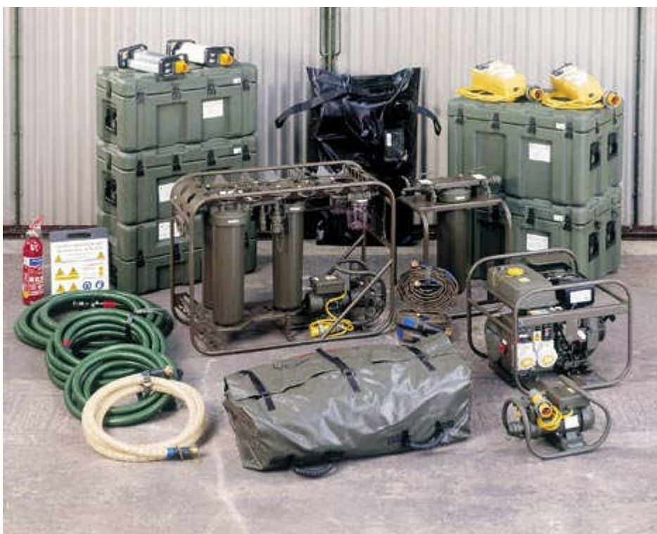
Slika 2: Prečiščevalna naprava (Stella-Meta WPU SG) z dodatki – za transport s padali
