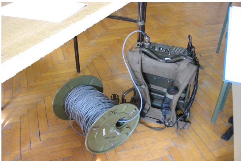
Slika 6: Priključni kabel v kolutu in naprava TADIRAN RC-40 (HF)
