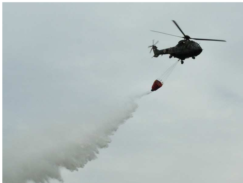
Slika 6: Gašenje požara z vodno vrečo, obešeno pod helikopterjem.
