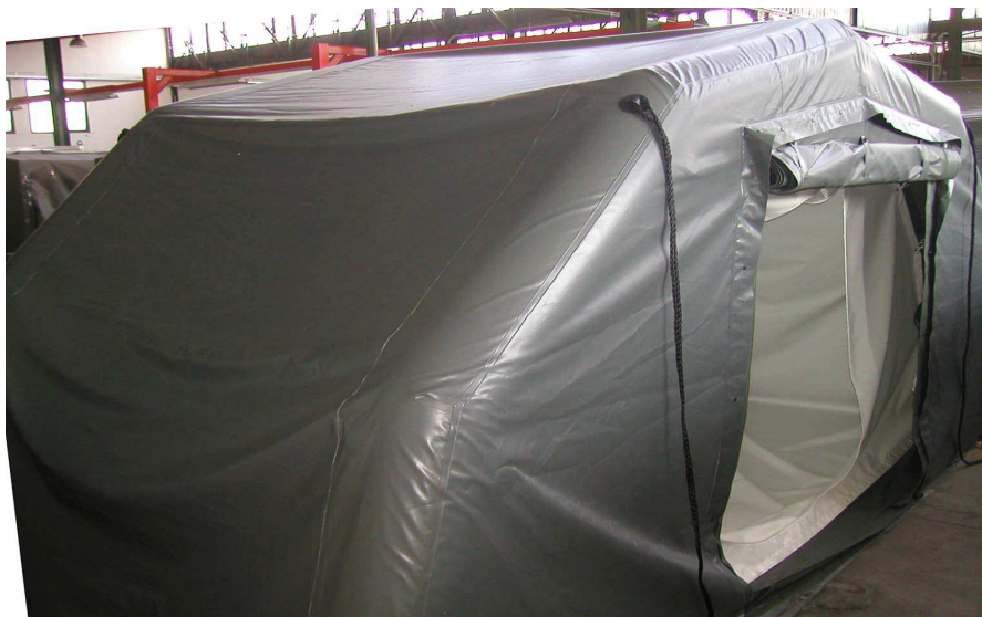
Slika 5: 2 obočni šotor za dekontaminacijo / detoksiifikacijo opreme
