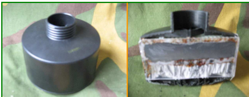
Slika 2: JRKB – filter in njegov prerez
