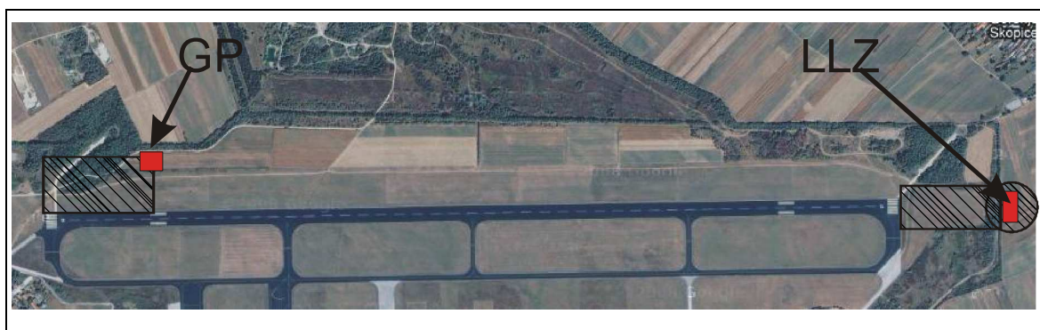
Slika 20: Postavitve oddajnikov GP in LLZ ter pripadajoče kritične cone
