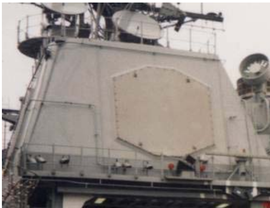
Slika 16: Antena SPY-1 na nadgradnji križarke AEGIS
