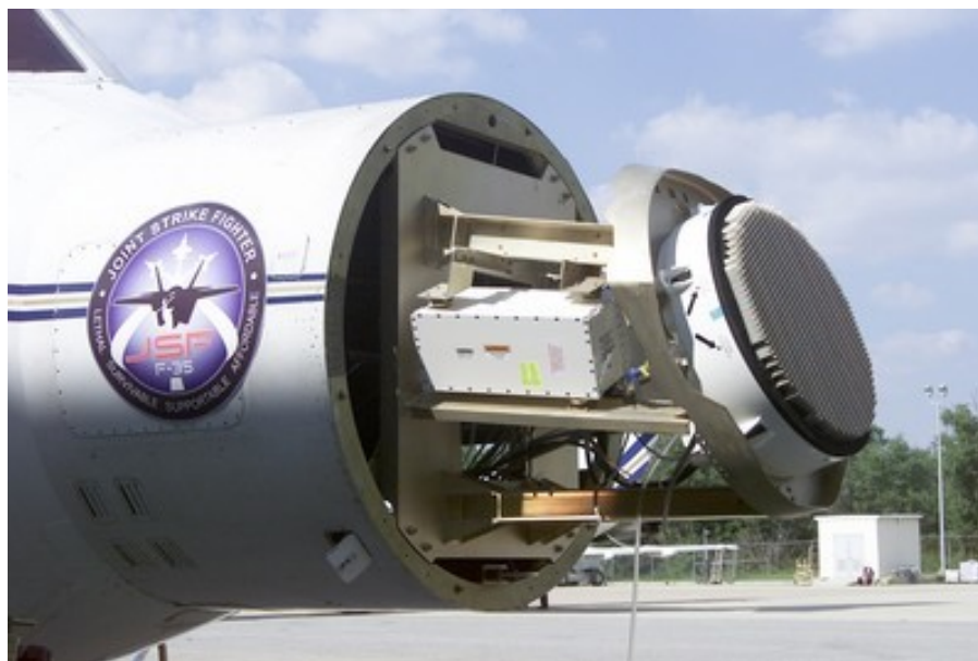
Slika 13: Radar AESA v demonstratorju tehnologije JSF
