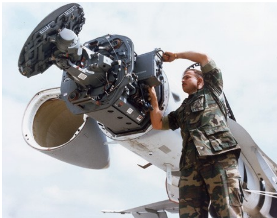
Slika 11: Radar z valovodno anteno APG-65 v letalu F/A-18A
