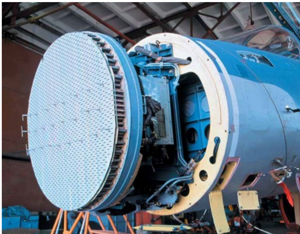
Slika 12: Radar s pasivno fazno rešetko NIIP N-011M na letalu Suhoj Su-30MK
