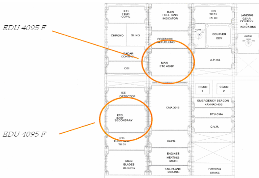
Slika 12: Lokacija EDU enot v pilotski kabini
