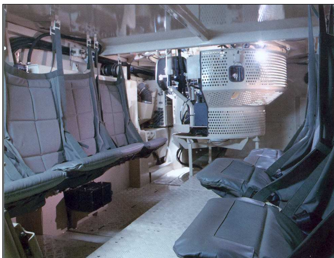
Slika 25: Posebni protiminski viseči sedeži
