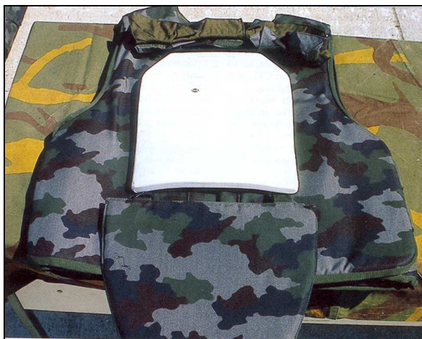
Slika 16: Zaščitni fragmentacijski jopič s ploščo iz balističnega polietilena
