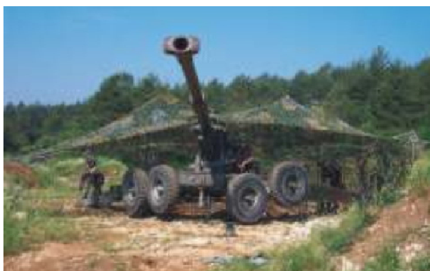
Slika 1: Top - havbica 155/45 TN 90 v položaju za delovanje.
