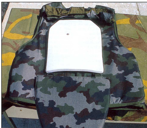
Slika 7: Zaščitni fragmentacijski jopič s ploščo iz balističnega polietilena
