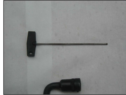
Slika 7: Ključ za pričvrstitev gorilnika
