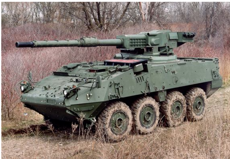
Slika 12: Top 105 mm je modificirana verzija tankovskega topa vgrajenega v tank M1 Abrams.
