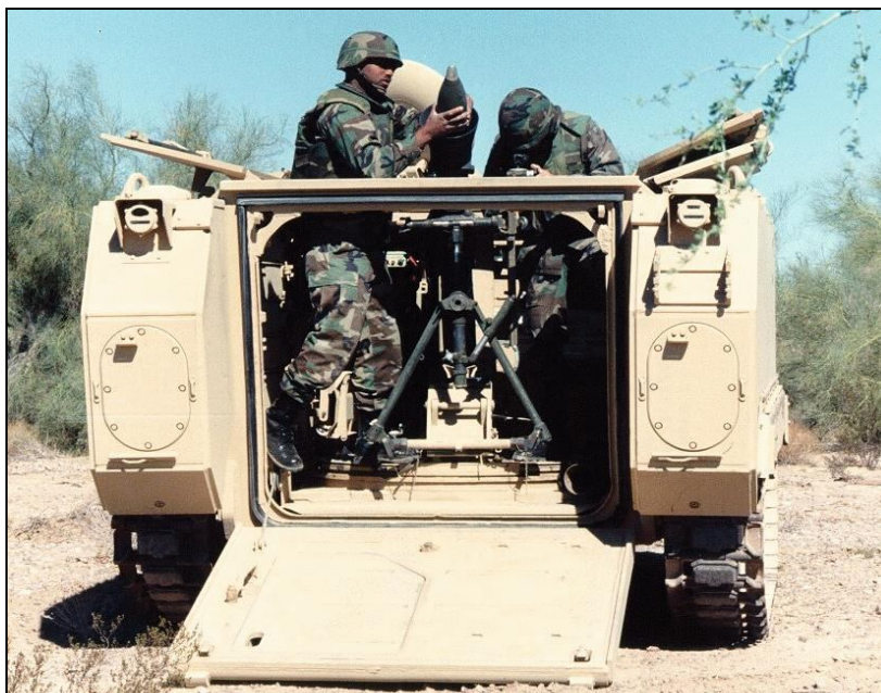
Slika 15: Vgraditev minometa s pomočjo dodatnega kompleta TT-6 v oklepno vozilo M113.
