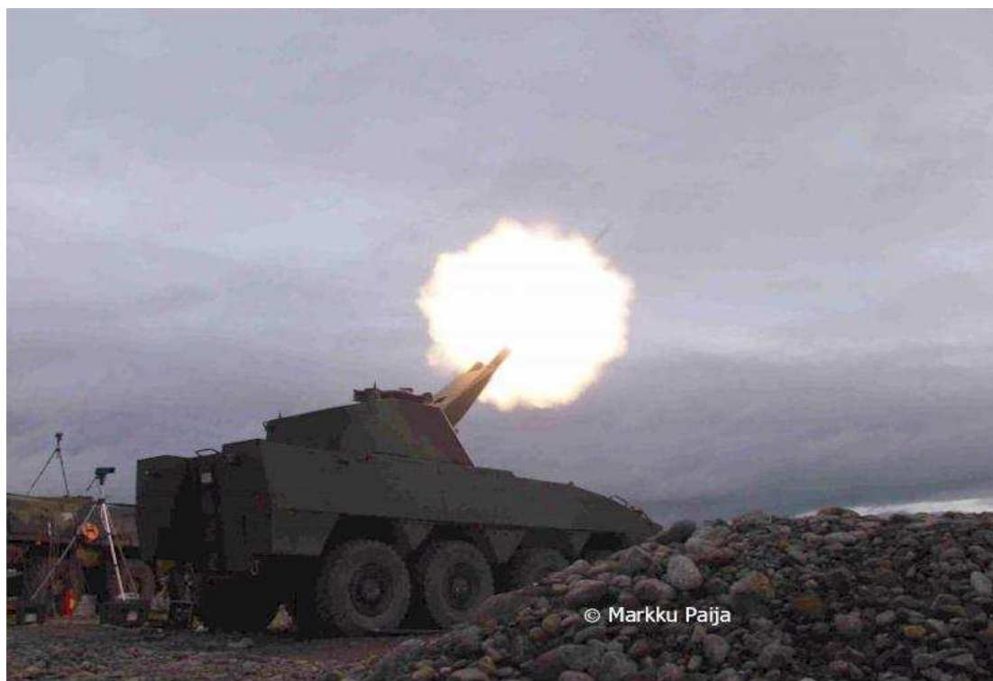
Slika 21: Sistem AMOS na vozilu Patria AMV med izstrelitvijo min
