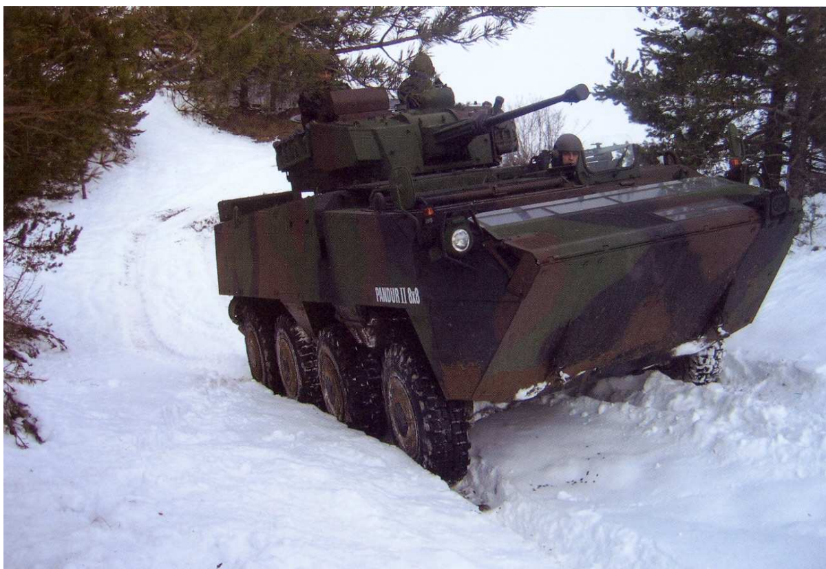
Slika 12: Srednje kolesno oklepno vozilo Krpan 8x8, opremljeno s kupolo in topom 30 mm
