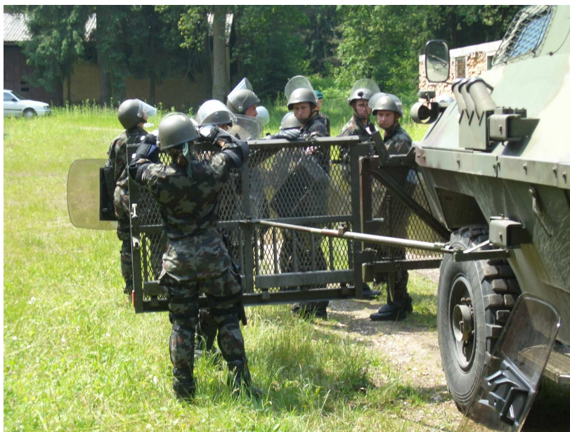
Slika 15: Postopek odpiranja ograje na vozilu BOV
