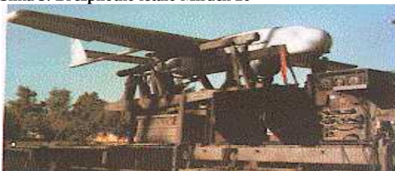
Talijanska letjelica Mirach 26 v pripravi za lansiranje s odlobovim lansirnim raketenim motorom. Na danjem dijelu trupa letjelice vidi se polukuglasto kušišče pokretnog girostabiliziranog nosača s izvidničkom opremom. Domet upravljanja ovom malom letjelicom iznosi 50 kilometara. Za navigaciju koristi u pasivnoj preprogramiranoj navigaciji rabi signale Omega/VLF navigacijskog sustava
