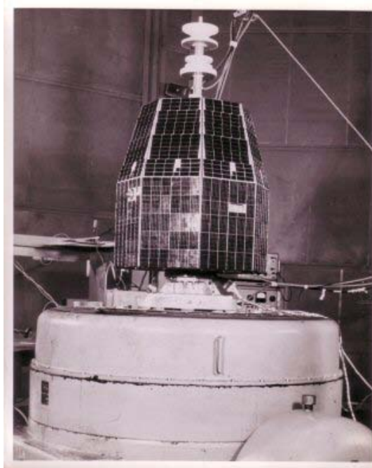
Slika 17: Ploščad za testiranje vibracij pri poletih v zraku in vesolju
