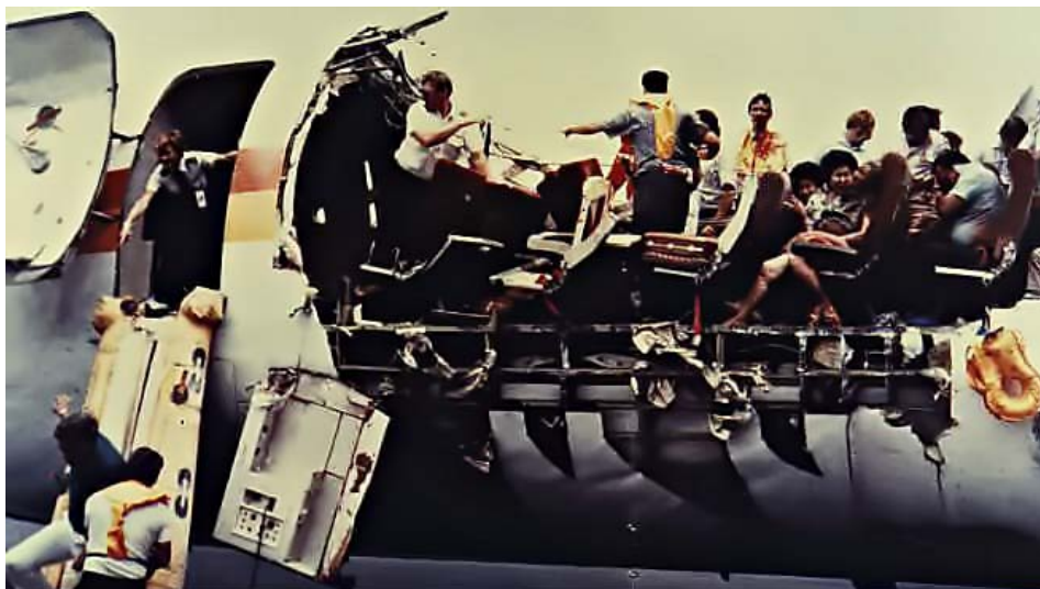
Slika 4: Ob nenadni (eksplozivni) poškodbi trupa letala so potniki doživeli nenadno dekompresijo
