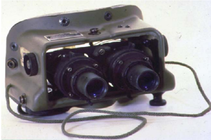
Slika 1: NVG tipa AN/PVS - 5
