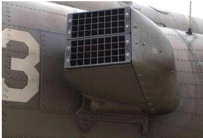
Slika 10: Prikaz namestitve dispanzerjev EM vab
