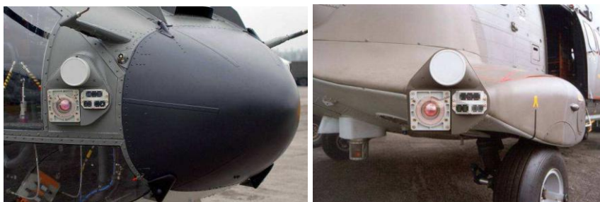
Slika 6: Prikaz namestitve LWR, MWR in RWR
