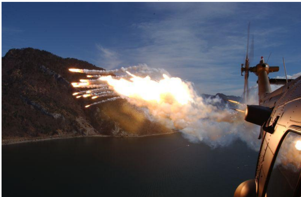
Slika11: Prikaz izmetavanje IR vab- Flare v zraku
