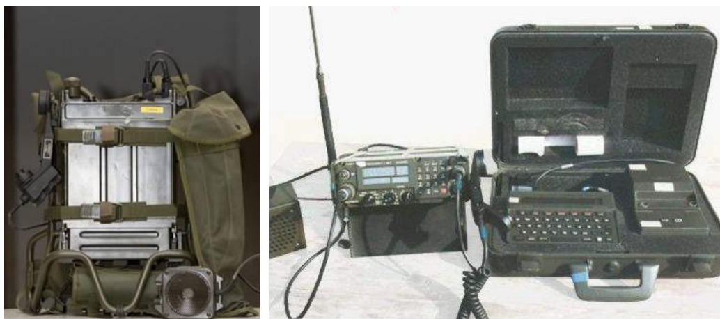
Slika 5.2: Prenosna radijska naprava PRC04 levo in PRC40 desno z vso pripadajočo opremo za prenos.
