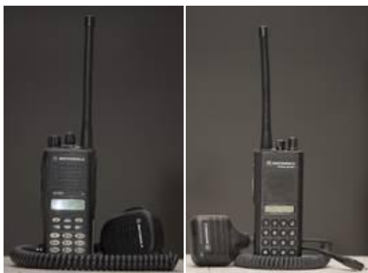
Slika 5.3: Radijska postaja GP300 (desno) in GP380 (levo) s pogovorko na PTT tipko.
