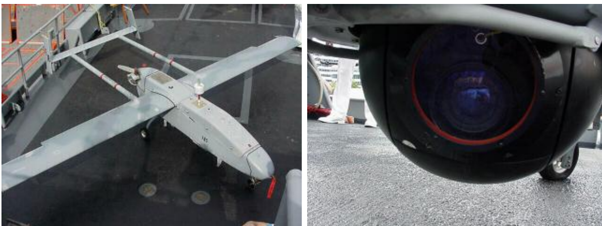
Slika 10.1: Pioneer UAV (levo) in pod njim montirana optično zajemalna naprava (desno).
