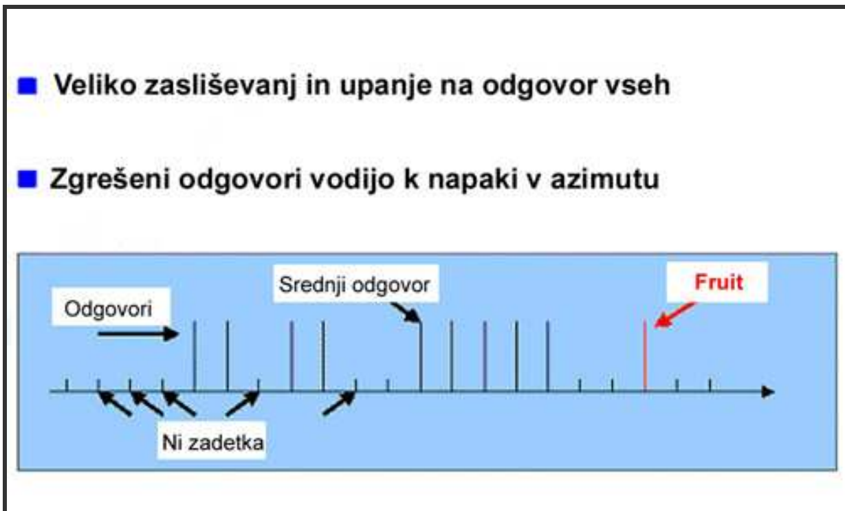
Slika 6: Merjenje kota s pomočjo tehnike pomičnega okna
