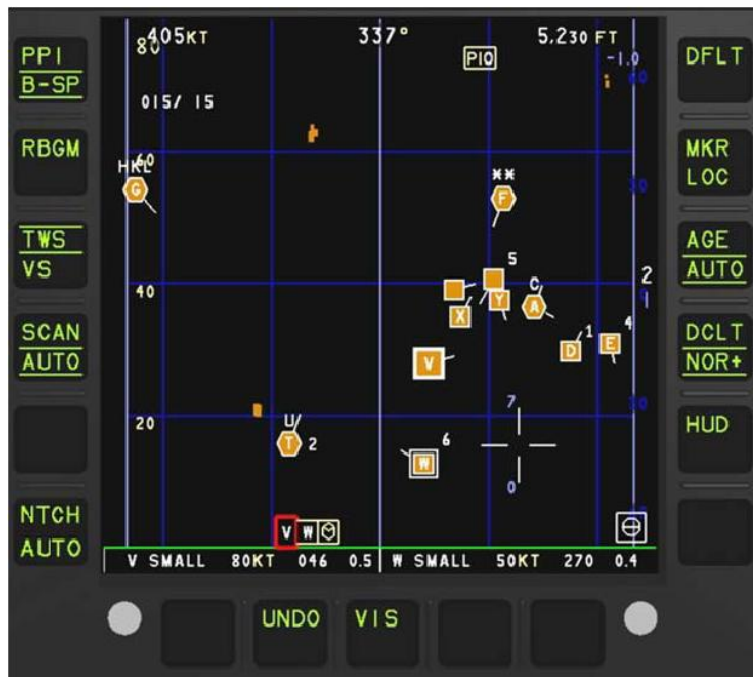
Slika 18 Slika radarskega prikaza, kjer so prikazani azimuti in razdalje do odkritih objektov.
