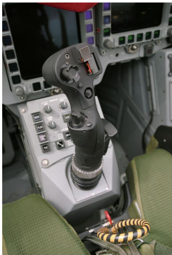
Slika 14 Številni gumbi na krmilni palici pilotu omogočajo kontrolo določenih sistemov z rokami na palici in ročici za potisk.
