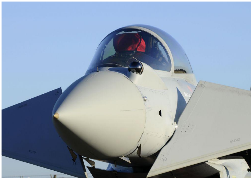
Slika 21 V izboklini na zgornji levi strani nosu letala se nahajajo senzorji sistema PIRATE.
