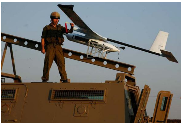
Slika 25: Skylark II na vzletni rampi na vozilu
