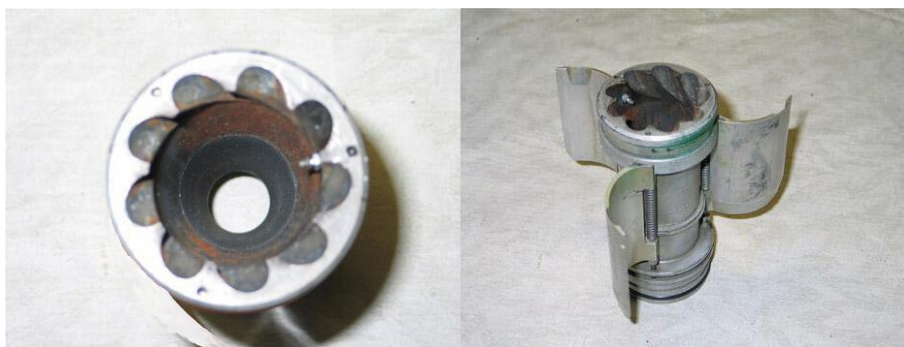
Slika 16: Šoba (levo) in montaža krilc (desno) motorja MK 66
