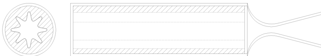
Slika 6: Shematski prikaz raketnega motorja s profilom osemkrake zvezde
